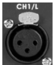
SE-600 имеет два симметричных трёхконтактных XLR разъема. Эти XLR входы связаны с переключателем Line/Mic, а также с выключателем фантомного питания ON/OFF. Эти входы могут использоваться как для обеспечения стереофонического сигнала (возможно от внешнего большого аудио микшера), или как два отдельных моно аудио канала для микрофонов левый (L/CH1) и правый (R/CH2).
