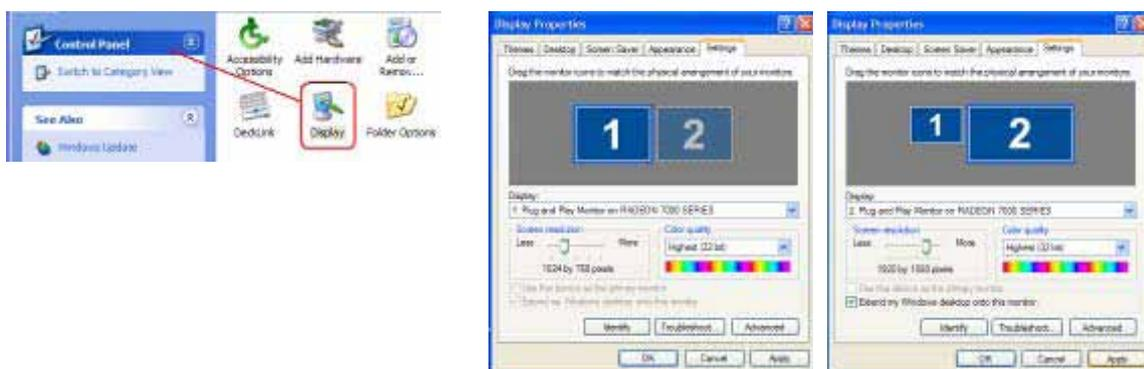
6. Видеокарта компьютера для 2-го монитора должна быть в режиме : 1920x1080, 1280x1024 или 1024x768.
